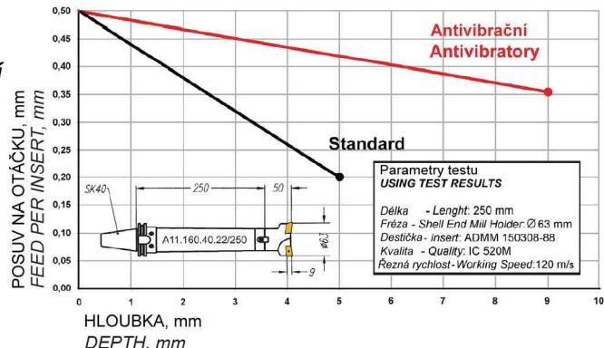
**Vibrace jsou redukovány až o 60% ve srovnání se standardním držákem oproti držáku vyrobeného s materiálu s antivibračními vlastnostmi.**
