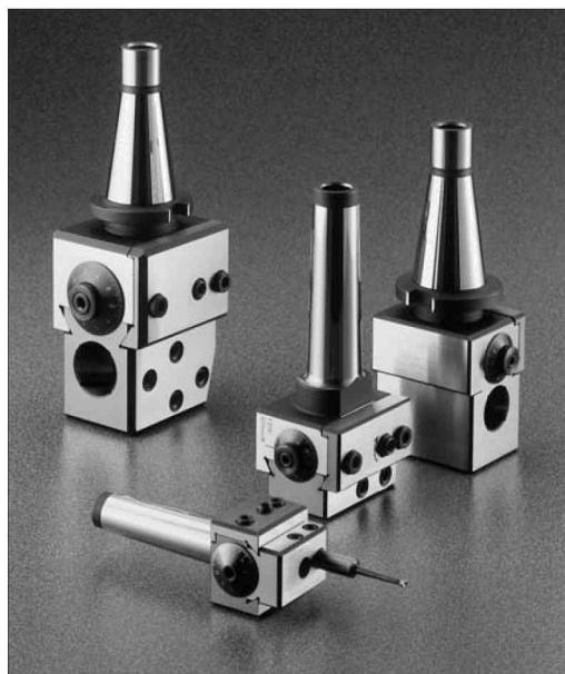
Vyvrtávací hlavy stavitelné se používají k přesnému vyvrtávání válcových otvorů na vyvrtávacích nebo i jiných obráběcích strojích. Upínací stopka je vyměnitelná – není součástí tělesa hlavy. Upínací otvory v saních jsou kruhové nebo kombinované pro upnutí kruhového a čtyřhlavého profilu těla nože. Hlavy se dodávají s příslušenstvím v dřevěných kazetách. Pracovní rozsah hlavy je udán v jejich označení (Vhs 5 – 50:  $d_{min} = 5 \text{ mm}$ ,  $d_{max} = 50 \text{ mm}$ ).
